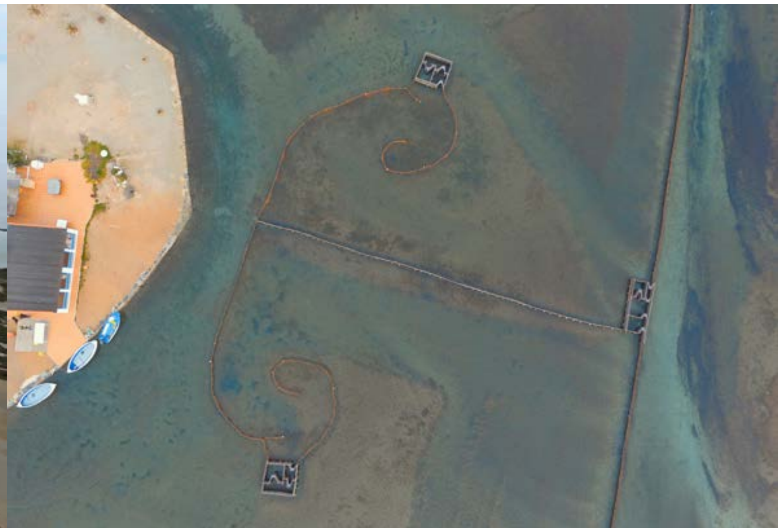
Vista aérea de la estructura de una encañizada: el corral, la paranza y la travesía.
